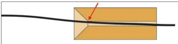
Abbildung: Drahtabrieb am Kontaktrohr
