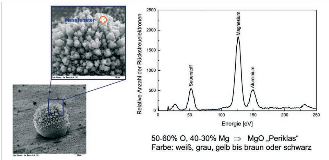
Abbildung: EDS-Analyse des schwarzen Niederschlags
