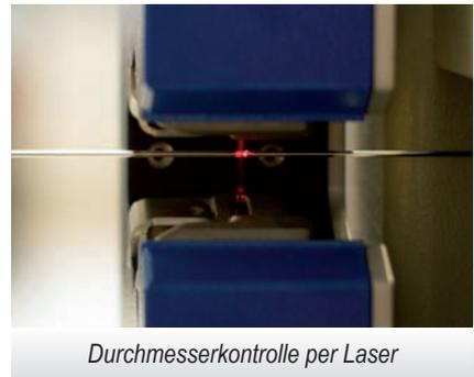
Durchmesserkontrolle per Laser
