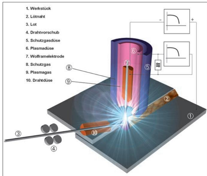
Abbildung: Schematische Darstellung Plasma-Löten
