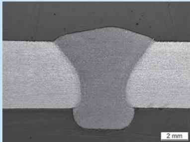
Makroschliff: Grundwerkstoff AW-6082, 5 mm, Schweißzusatz MA-6063 1,2 mm
