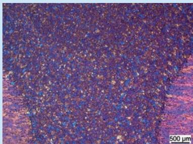
Feinkörniges Gefüge durch TiB-Partikel
