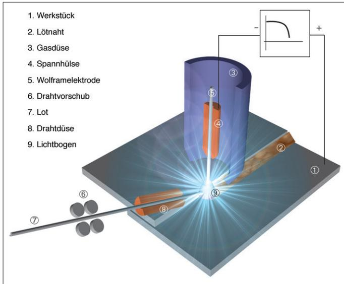
Abbildung: Schematische Darstellung WIG-Löten
