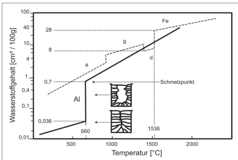
Abbildung: Löslichkeit von Wasserstoff in Aluminium und Eisen
