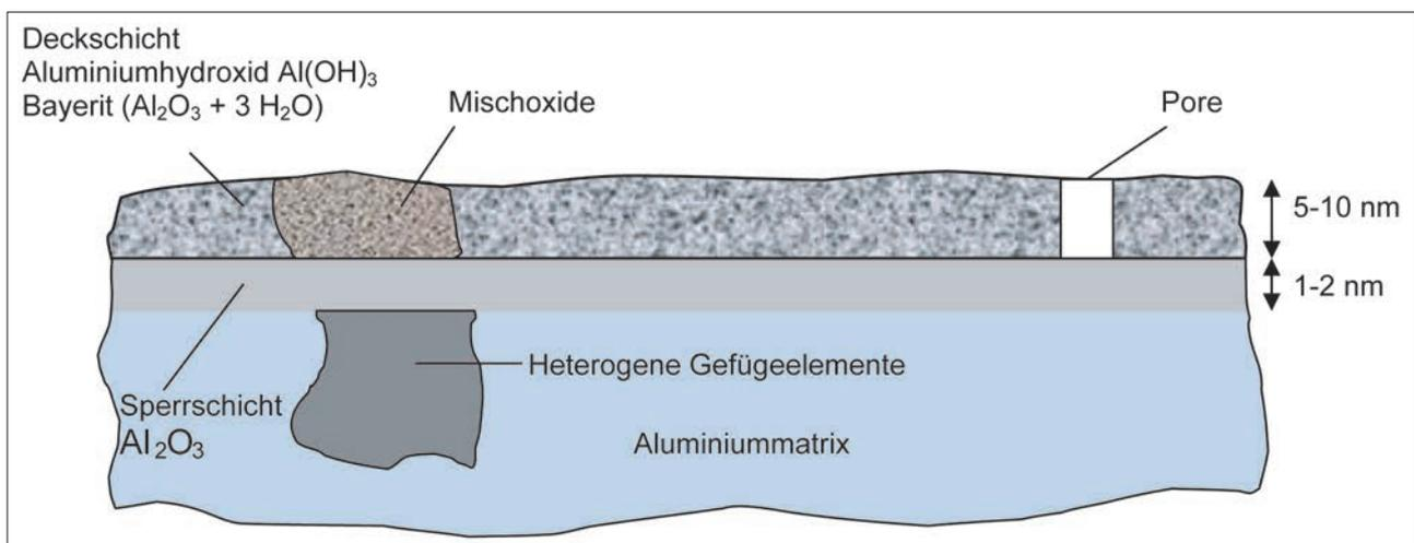
Abbildung: Aufbau einer natürlichen Oxidschicht (schematisch)
