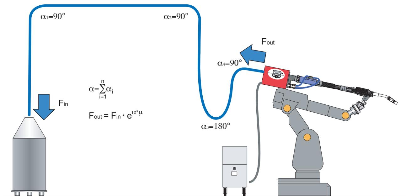
Schematische Darstellung eines Roboterschweißsystems mit Fassdrahtversorgung und auftretenden Reibungskräften
