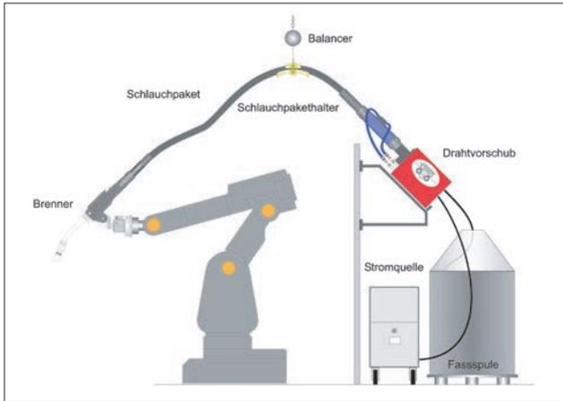
Zum Abspulen von B-400 40 kg Spulen sind spezielle Abspulvorrichtungen notwendig, während dies bei den Öko- und Jumbo-Fässern nicht notwendig ist. Es ist jedoch auf eine möglichst kurze Verbindung des Fasses mit dem Drahtvorschubgerät (siehe Abbildung) zu achten. Falls längere Verbindungen zwischen Fass und Drahtvorschubgerät notwendig sind empfehlen wir unseren **Rolliner**.
