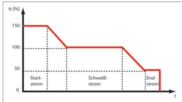
Abbildung: Stromprogramm mit erhöhtem Anfangs- und verringertem Endstrom
