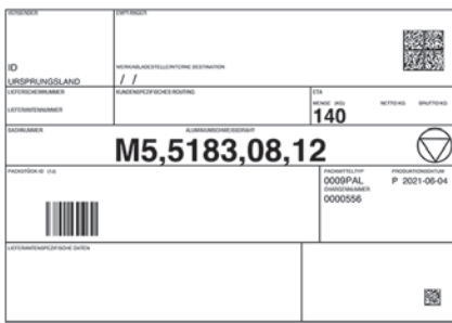
Datamatrix code (VDA-label) für Chargennummer, Gewicht, Produktionsdatum und Artikelnummer
