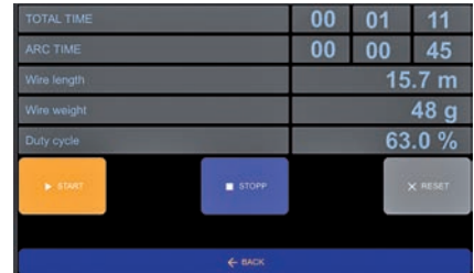
Stoppuhrfunktion für Drahtverbrauch, Einschaltdauer und Schweißzeit
