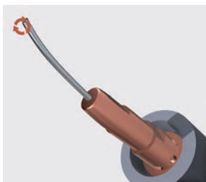
Kreisende Drahtspitze bei nicht geraden Drähten
