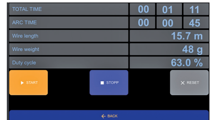
Stoppuhrfunktion für Drahtverbrauch, Einschaltdauer und Schweißzeit
