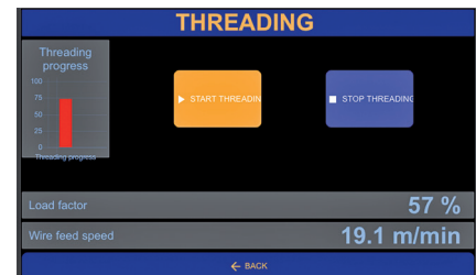
Einfädelfunktion - fädelt den Draht mit einer vorgegebenen Länge ein
